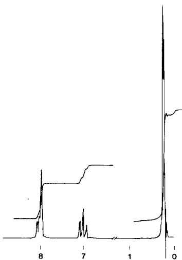
Fig. 2. 60 MHz ^1\text{H} NMR spectrum of 3-fluoro-4-chlorodimethylsilylpyridine ( C ).
